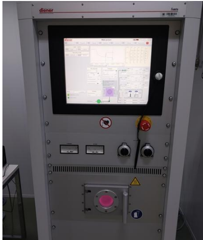
Fig.4.18. Activación por plasma de las superficies para la integración del microsensar de flujo.
