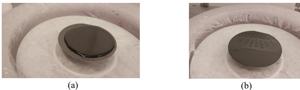
Fig.4.14 (a) Aplicación de SU-8 sobre oblea de silicio montada en spin coater . (b) SU-8 luego del proceso de spin coating .
