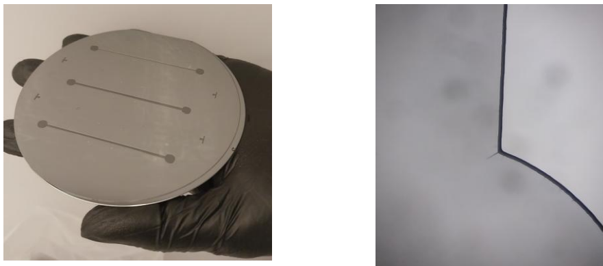
Fig.4.16. (a) Microcanales luego del proceso de revelado.(b) Microscopía para verificación de estructura del inlet/outlet en SU-8.
