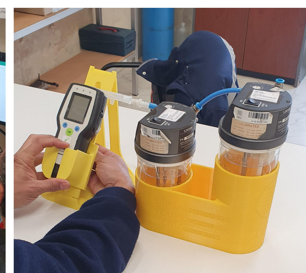
Verificación de etilómetros del equipo de metrología legal La Rioja con soportes personalizados fabricados con impresión 3D
