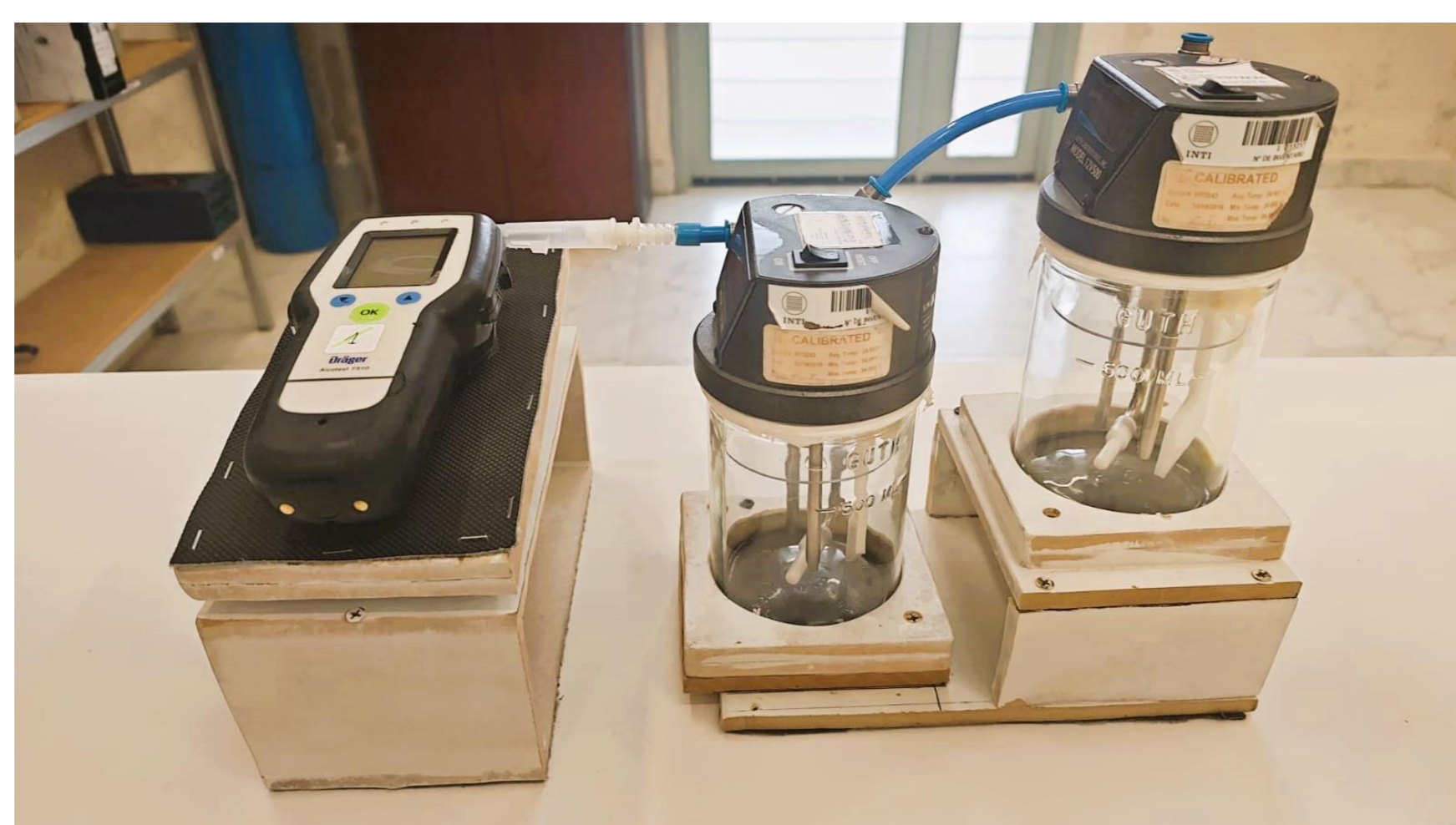
▪ Sistema de verificación de etilómetros en soportes artesanales de madera.
