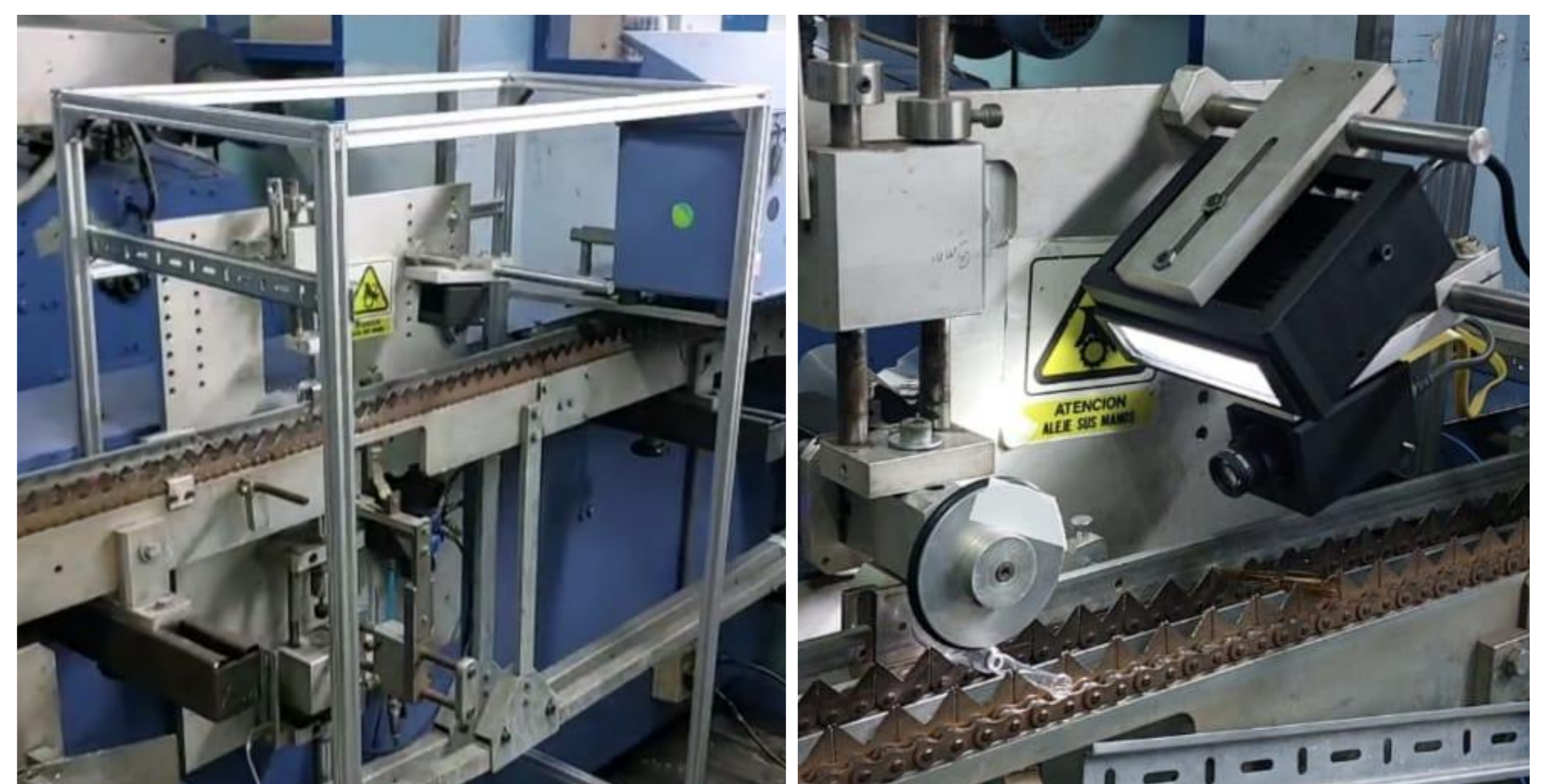
• Pruebas de campo cabina, iluminación y toma de imágenes.
