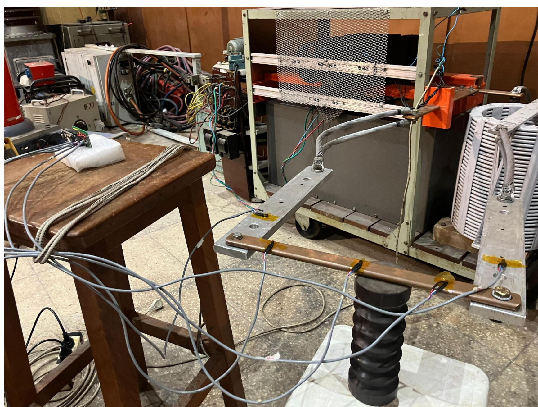
• Barra de cobre siendo calentada con una fuente de corriente.
