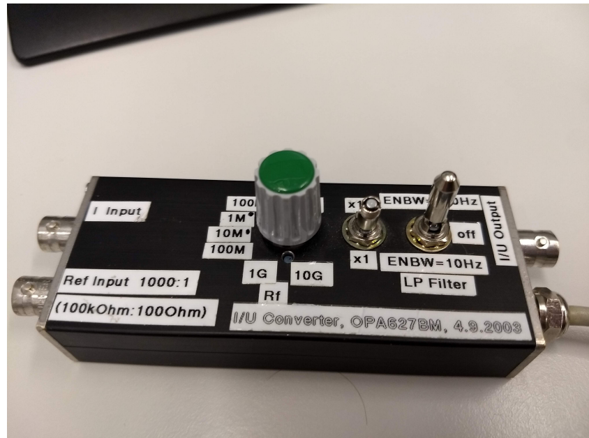
Figura B.1: Imagen del convertor I-U utilizado para las mediciones de conductancia. La respuesta de este dispositivo en el rango de 0 kHz a 1 kHz resultó ser plana. Está basado en un OPA627BM.
