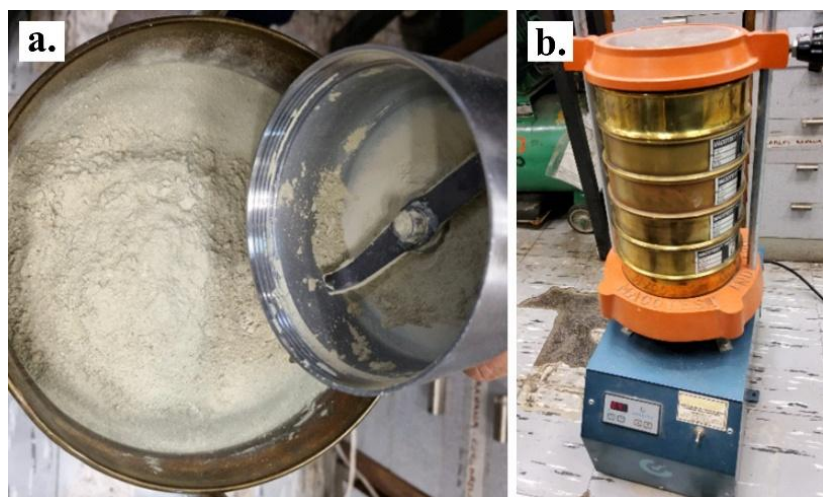
Figura C-1. Esquema del proceso de obtención tamaños de partícula de zeolitas: Molienda en equipo desintegrador de alta velocidad (a) y Tamizado secuencial (b).
